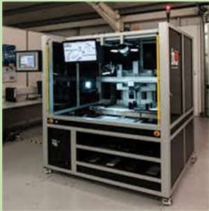
ماشین اندازه برداری تصویری (VMM) پویش ماشین سال ۱۳۹۲ به سفارش شرکت طراحان صنعت پارسپان
